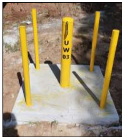
รูปที่ 2-19 ป่อสังเกตการณ์ (Monitoring Well) บริเวณพื้นที่โครงการ
