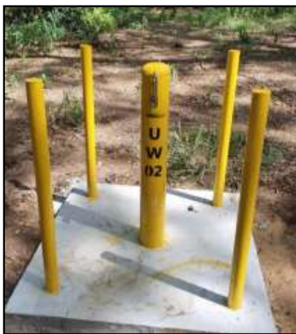
รูปที่ 2-19 ป่อสังเกตการณ์ (Monitoring Well) บริเวณพื้นที่โครงการ
